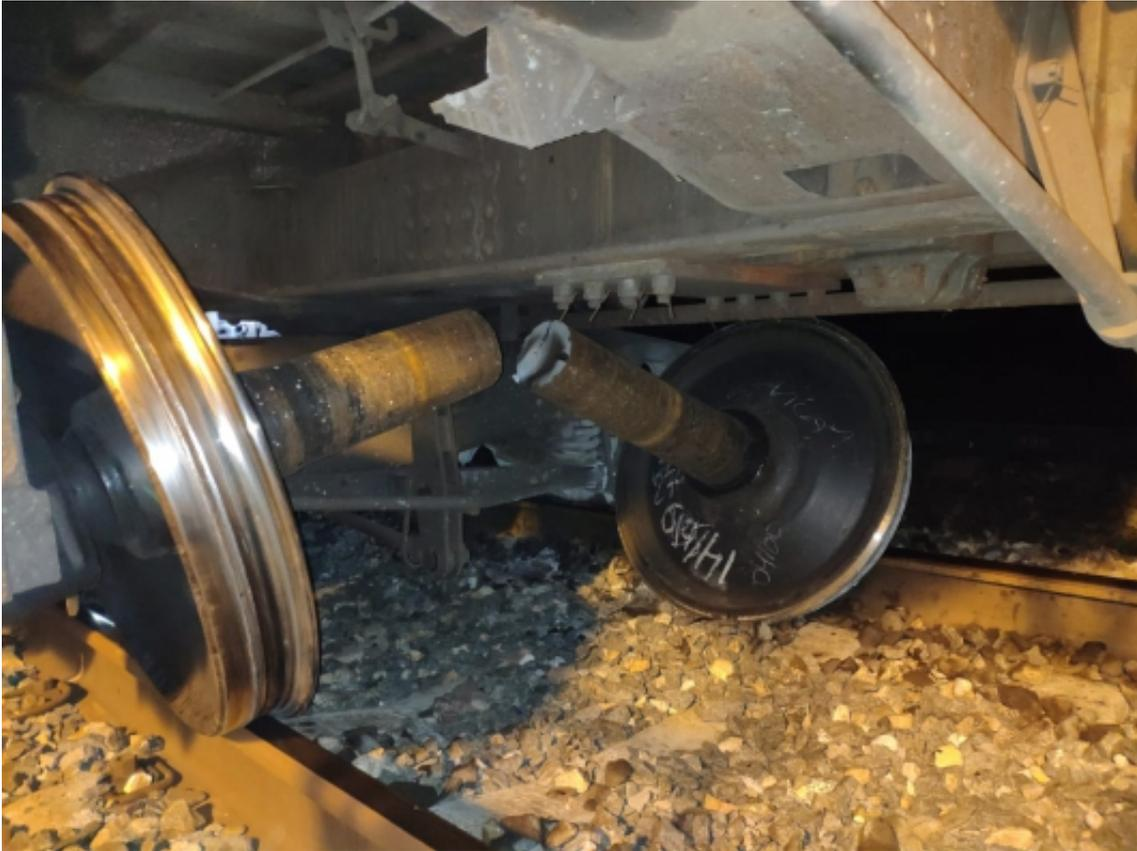
Проверкой установлено, что в 21 час 10 минут 04.07.2021 на 761 км 7 пк перегона Асеевская - Канаевка Куйбышевской железной дороги в результате разлома оси колесной пары произошел сход грузового вагона грузового поезда №2611. В результате происшествия пострадавших нет, железнодорожный вагон получил повреждения.
