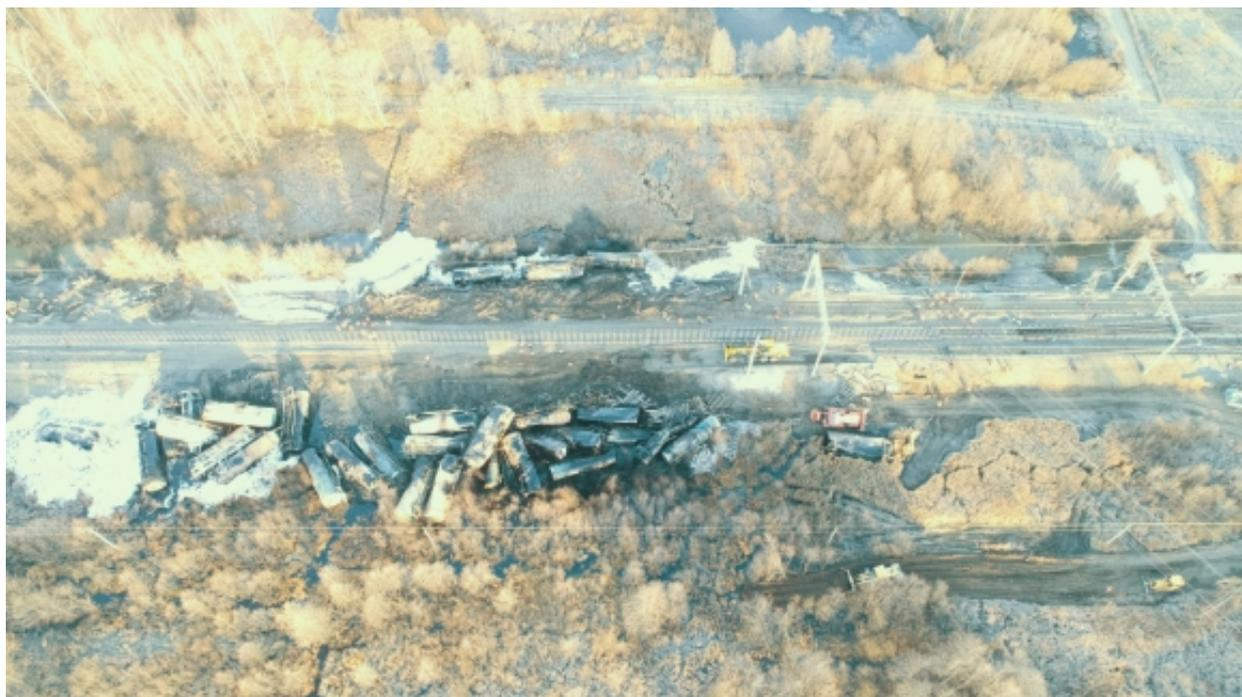
Установлено, что днем 16 ноября 2020 на железнодорожных путях в месте схода поезда проводились ремонтные работы. Железнодорожники при приближении поезда не успели подключить стрелку к приводу, что привело к переводу части вагонов грузового поезда на другую железнодорожную ветку и их сход с рельсов.
